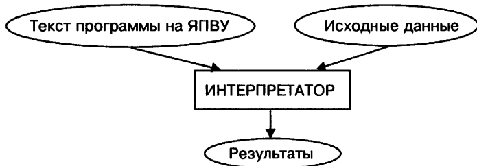
Рис. 6.20. Выполнение программы на ЯПВУ с использованием интерпретатора
